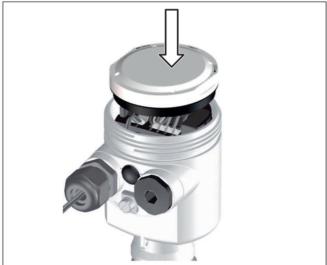
Fig. 3: Insert display module
